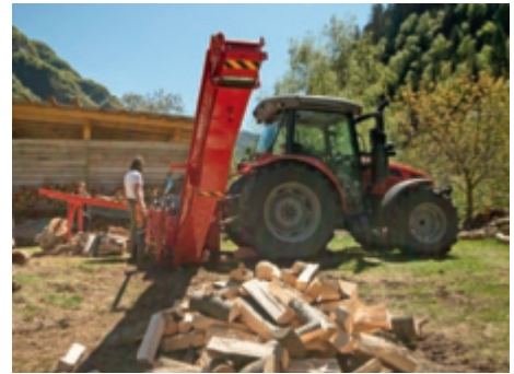
Hinten kommen ganze Baumstämme rein, und vorne fallen gleichmässige Holzscheite raus.
