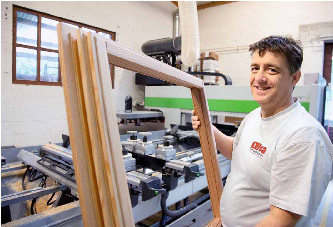
Diesen Fensterrahmen hat die CNC-gesteuerte Maschine innerhalb weniger Minuten ohne Zutun von Matteo Oliva gefräst.
